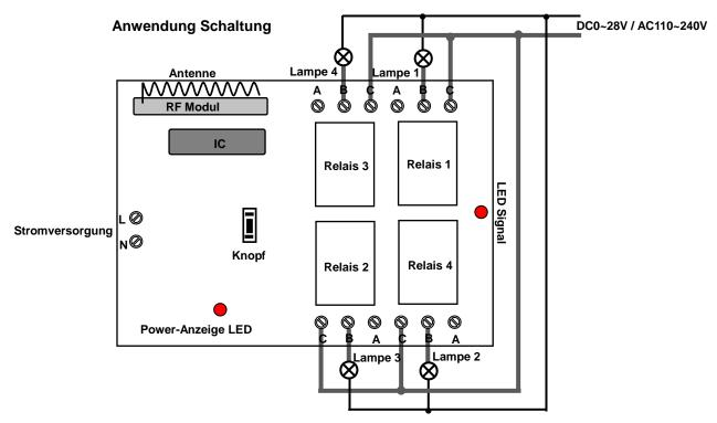
A, B=Normalerweise geschlossen; B, C=Normalerweise geöffnet.
