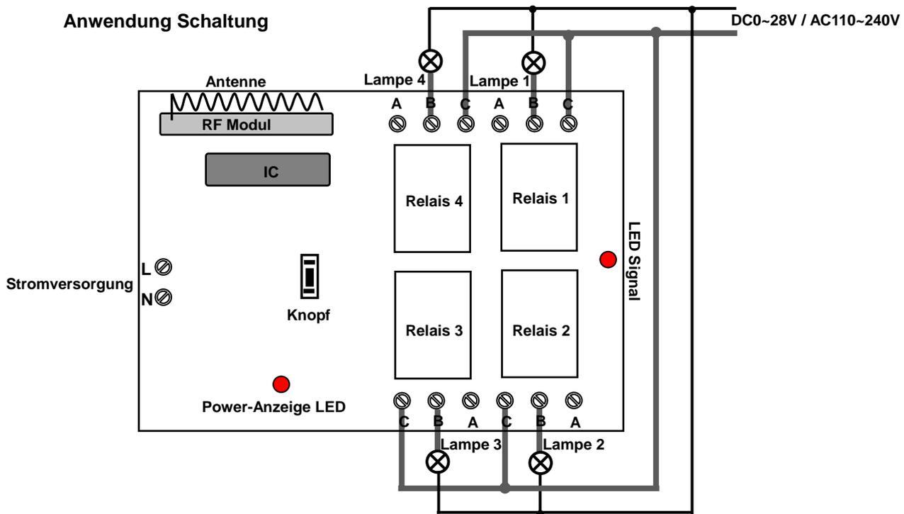
A, B=Normalerweise geschlossen; B, C=Normalerweise geöffnet.
