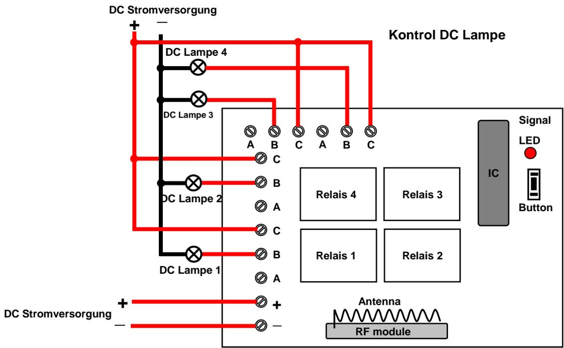
A, B=Normalerweise geschlossen; B, C=Normalerweise geöffnet.
