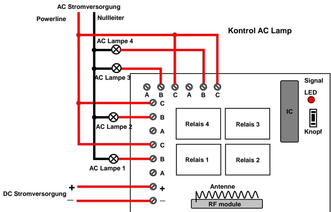
A, B=Normalerweise geschlossen; B, C=Normalerweise geöffnet.
