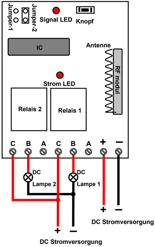
A, B=Normalerweise geschlossen; B, C=Normalerweise geöffnet.
