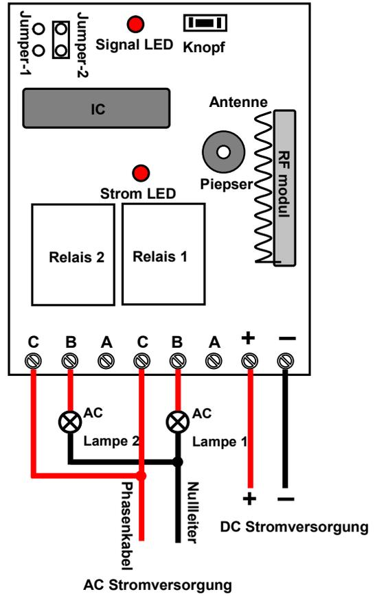
A, B=Normalerweise geschlossen; B, C=Normalerweise geöffnet.
