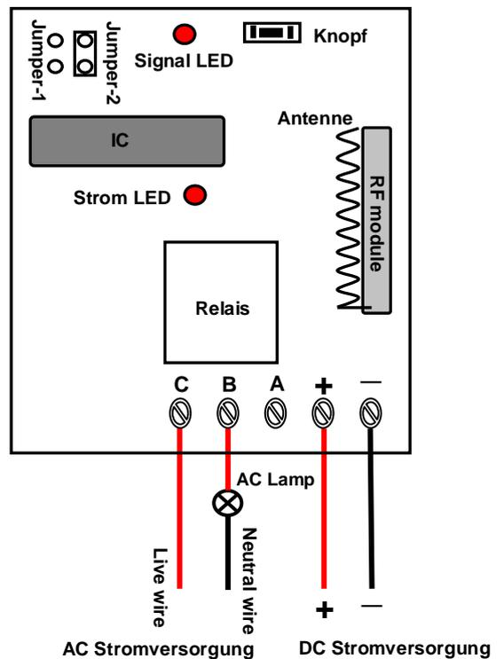
A, B= Normalerweise geschlossen; B, C= normalerweise geöffnet.
