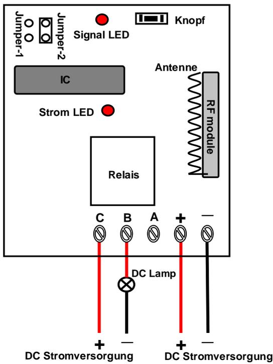
A, B= Normalerweise geschlossen; B, C= normalerweise geöffnet.
