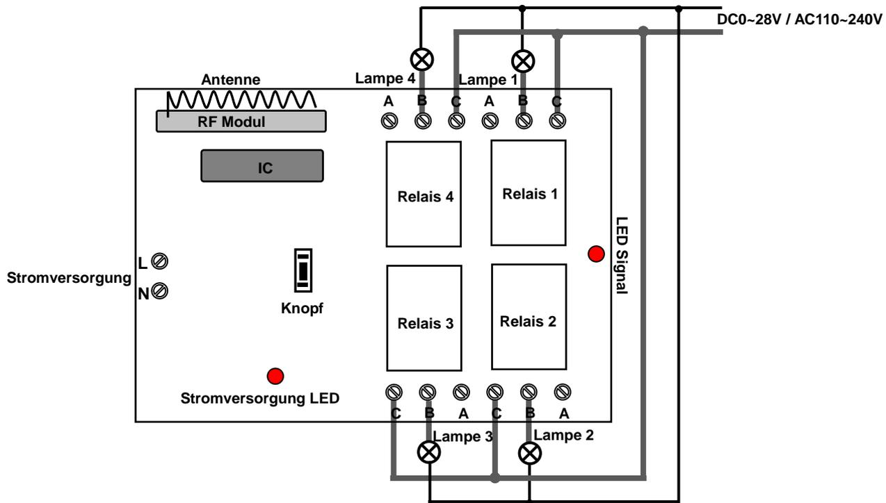
A, B=Normalerweise geschlossen; B, C=Normalerweise geöffnet.
